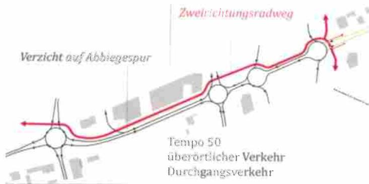
Abbildung 19: Reduzieren der Zahl notwendigen Abbiegespuren durch Kreisel
