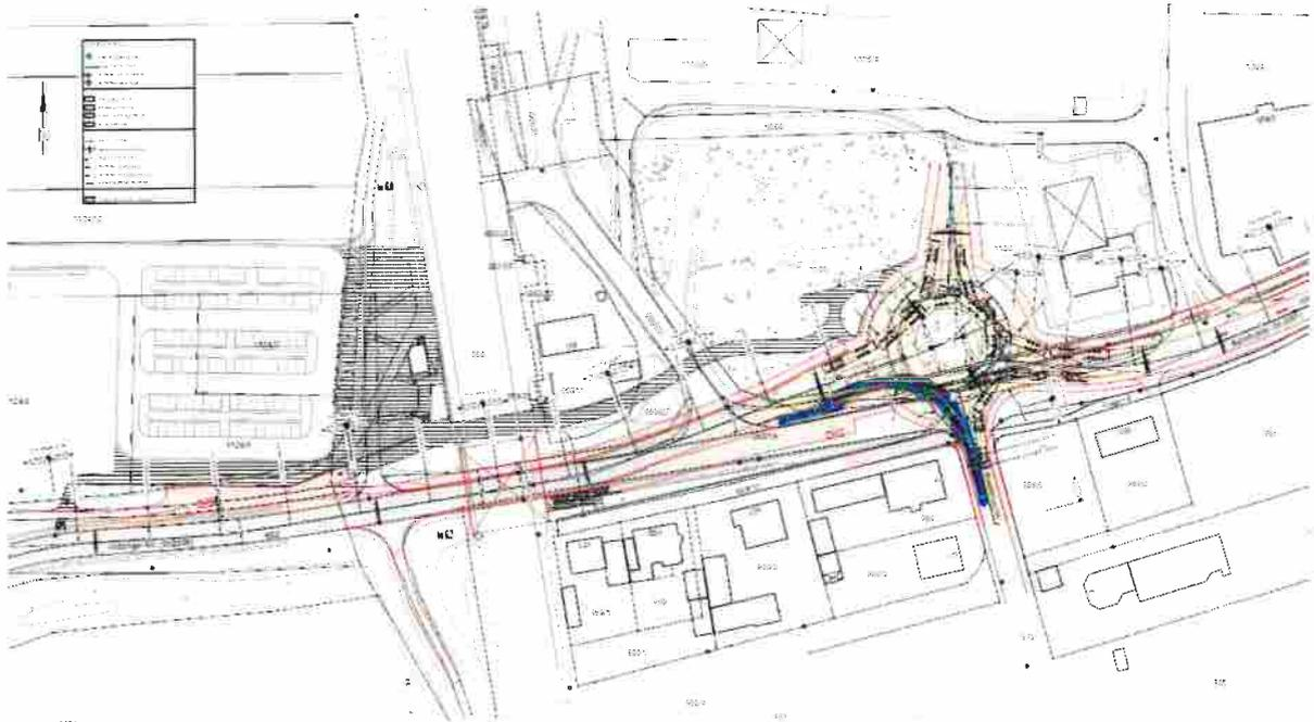
Abbildung 21: Vorentwurf St 2036 / Bahnhofstraße: Verbesserung der Verkehrsverhältnisse und Alage von Bushaltestellen (Quelle: Straßenlageplan, Büro FISCHER, Leipheim, 2015)
