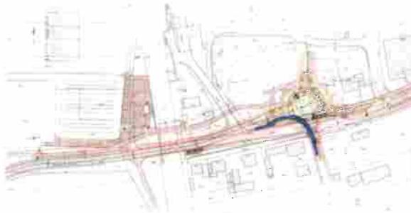
Abbildung 5: Vorentwurf Straßenlageplan St. 2036 / Bahnhofstraße, Verbesserung der Verkehrsverhältnisse und Anlage von Bushaltestellen (Bahnhofsareal) 2015, Büro FISCHER
